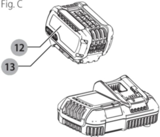
2. Insérer le bloc-piles **12** dans le chargeur, en vous assurant qu'il y est correctement calé. Le voyant rouge (charge) clignotera de façon continue indiquant que le cycle de chargement a commencé.
