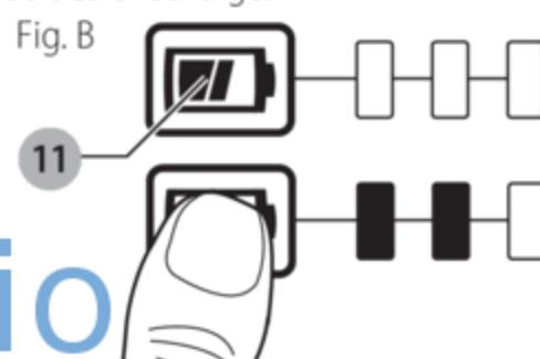
**REMARQUE :** le témoin de charge ne fait qu'indiquer le niveau de charge du bloc-piles. Il ne donne aucune indication quant au fonctionnement de l'outil. Son propre fonctionnement pourra aussi varier en fonction des composants produit, de la température et de l'application d'utilisation.
