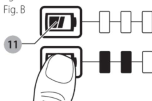
**NOTA:** El indicador de carga es sólo eso: un indicador de la carga de la unidad de batería. No indica el nivel de funcionalidad de la herramienta y puede variar de acuerdo a las piezas del producto, la temperatura y la aplicación que el usuario le dé.
