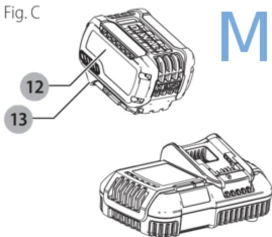
2. Inserte la batería 12 en el cargador, comprobando esté bien fija. La luz roja (de carga) parpadeará continuamente para indicar que se ha iniciado el proceso de carga.
